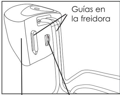
Control de la freidora Interruptor de seguridad
